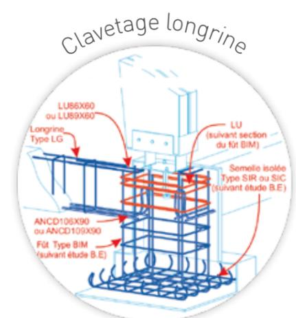
⚠ Si un cadre du fût BIM est coupé pour faciliter l'introduction des crosses ANCD, il est impératif d'ajouter des liaisons LU comme indiqué sur le schéma pour remplacer les cadres coupés.
