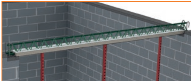
3 Pose des étais espacés de 1,5 m maximum.
