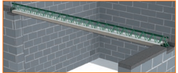
2 Mise en place. Appuis sur maçonnerie = 5 cm.
