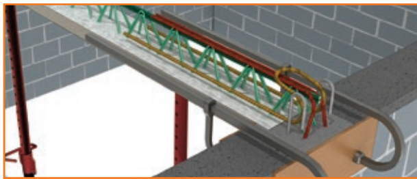
5 Coffrage + clavetage de la poutre.
