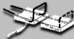
COUPER Pratiquer une coupe du côté de la pastille puis refermer l'extrémité avec un adhésif
