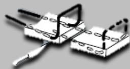
COUPER Pratiquer une coupe du côté de la pastille puis refermer l'extrémité avec un adhésif
